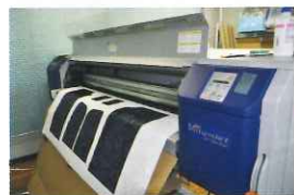
【昇華】まず転写紙に印刷をします → 次に熱と圧力で生地にインクを写します 【自動裁断機】カメラで確認してAIが判断。台に置かれた生地を自動で裁断します。
