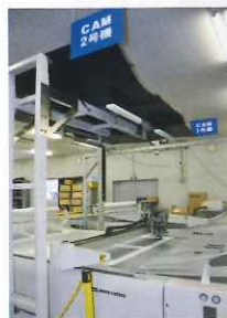
【昇華】まず転写紙に印刷をします → 次に熱と圧力で生地にインクを写します 【自動裁断機】カメラで確認してAIが判断。台に置かれた生地を自動で裁断します。
