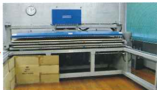
【昇華】まず転写紙に印刷をします → 次に熱と圧力で生地にインクを写します 【自動裁断機】カメラで確認してAIが判断。台に置かれた生地を自動で裁断します。
