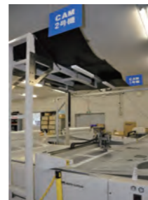
【昇華】まず転写紙に印刷をします → 次に熱と圧力で生地にインクを写します 【自動裁断機】カメラで確認してAIが判断。台に置かれた生地を自動で裁断します。
