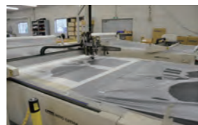
【昇華】まず転写紙に印刷をします → 次に熱と圧力で生地にインクを写します 【自動裁断機】カメラで確認してAIが判断。台に置かれた生地を自動で裁断します。
