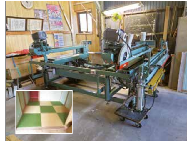
左下:へりなし畳 背面:両框自動チップソー裁断付自動表貼縫着機
